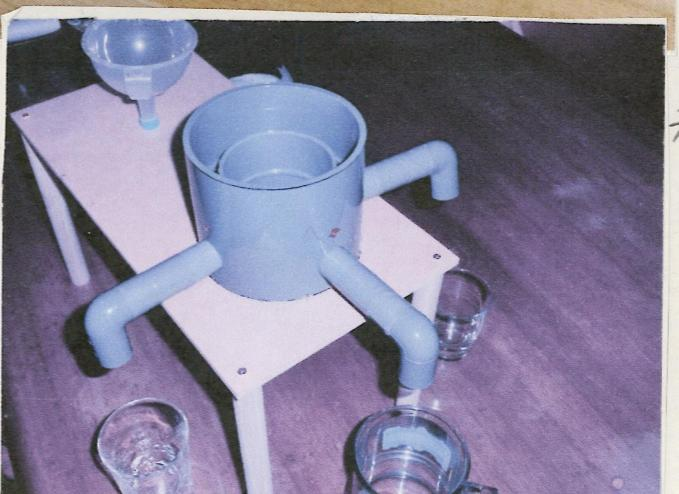
投入口に水を入れるとホースをたどってます。小さい円に水がたまります。あふれてくると大きくなっています。たまって3つの出口までくると3つの出口から同じ量の水がでてきます。手を洗う時はそのまま使います。水やお茶を飲むときは下にコップをおきます。円筒分水の中にしきりをつけないと出る水の量がかかるので3つの水量を変えたい時にも対応できます。
