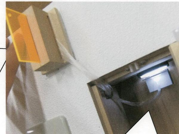
照明の光をレンズで集め、光ファイバーで部屋の外の装置へ光を送り出します。
