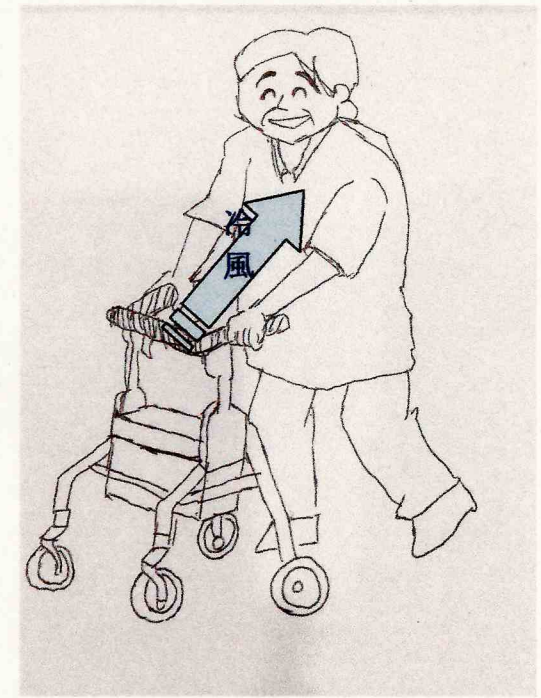
外気温監視ユニット 30度以上であれば冷却ユニットに電流を流す(30度以下になれば電流を止める)
