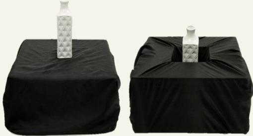
地震が発生した時に展示品を保護することが出来る装置です。地震が発生すると転倒防止のため中央の台の部分が一瞬に下がります。展示品は布に包まれて保護され、台の下に取り付けられた磁石の反発力により、衝撃や強い揺れから守ります。装置は重りの落下により動作する仕組みのため、停電や電池切れを心配することはありません。
